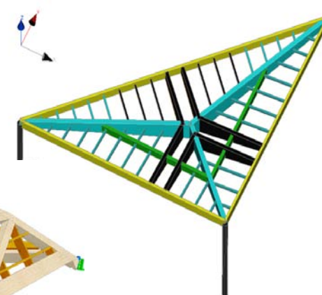
Perspectives des modules : extraits plans PAC (Shed) et modélisation (caisson)
